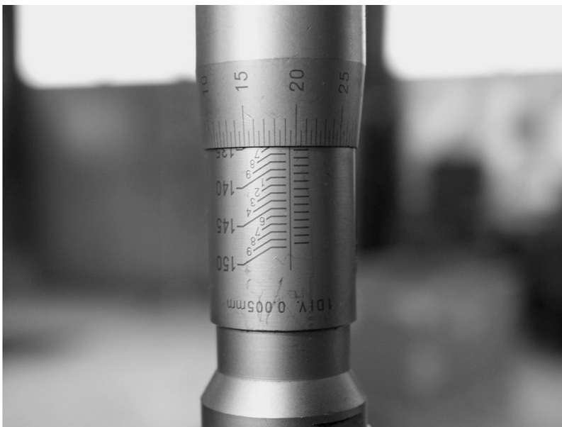
Slika 9. Izmjerene vrijednosti trokrakim mikrometrom
