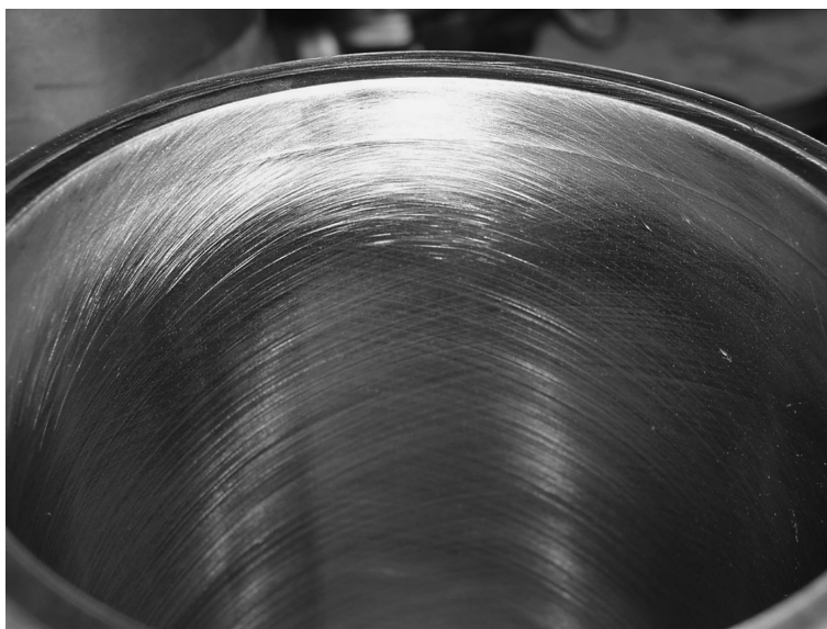
Slika 7. Izgled cilindarske košuljice, na kojoj je blago, brusnim papirom skinut maleni sloj čadi u dijelu kompresionog prostora. Na ostaloj površini se jasno vide tragovi tvorničke strojne obrade
