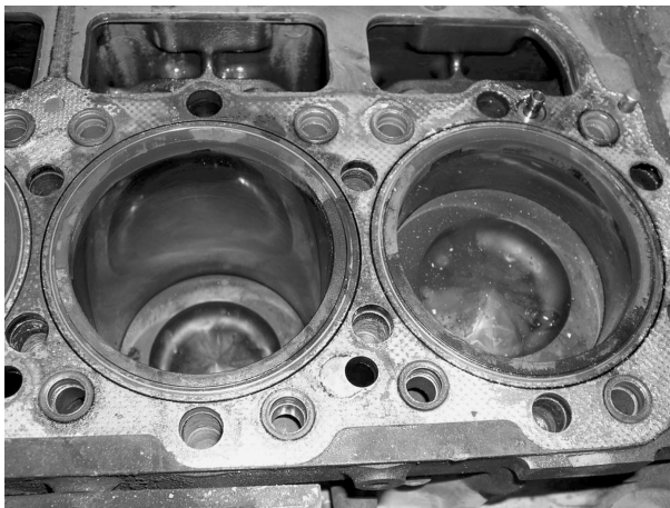
Slika 2. Motor nakon demontirane glave
