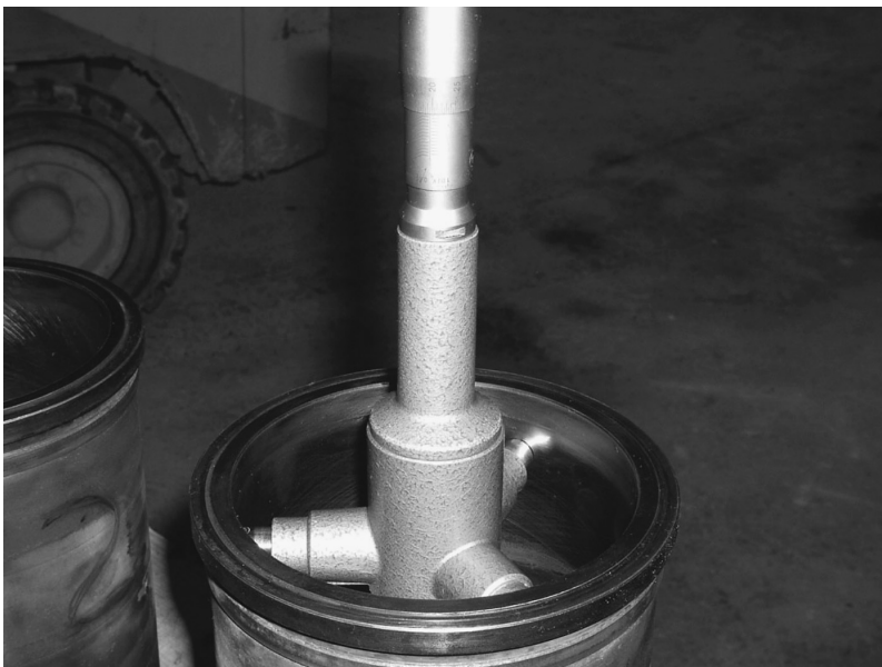
Slika 8. Mjerenje cilindarske košuljice trokrakim mikrometrom
