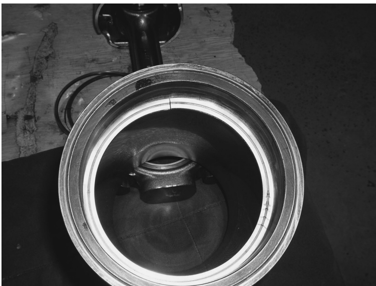
Slika 10. Uljni klipni prsten u cilindru
