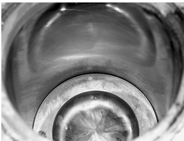
Slika 3. Nedemontiran klip u cilindru
